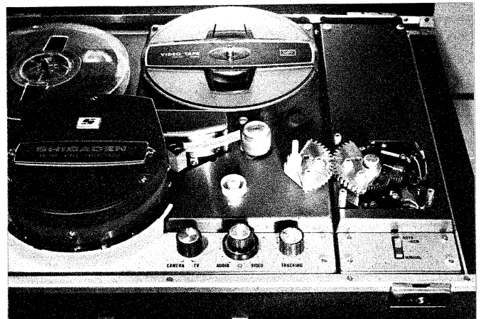
Bild 3. Rechts die angebaute Umschalteneinrichtung für den automatischen Bandrücklauf
