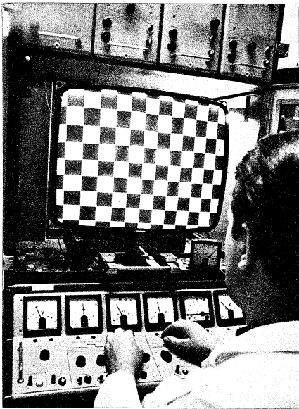
Bild 4. 61-cm-Schwarzweiß-Bildröhre B 61 G 1 mit „Selbond“-Implosionsschutz auf dem Prüfstand
